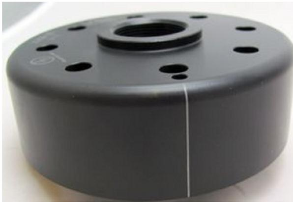
Sehen Sie sich jetzt den Rotor an, auf seinem Außenumfang finden Sie eine kleine Markierung (gekerbte Linie). Hier auf dem Bild zur besseren Erkennbarkeit weiß hervorgehoben.
